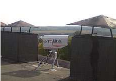
Атмосферная оптическая система передачи данных M1 ARTOLINK (ООО МОСТКОМ) в Белгороде - дистанция связи 0.8 км
